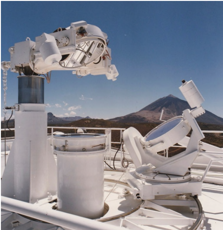
Bild 31. Coelostat des Vakuum-Turm-Teleskops. Im Hintergrund der 3716 Meter hohe Pico de Teide. (W. Schmidt, 1988)
