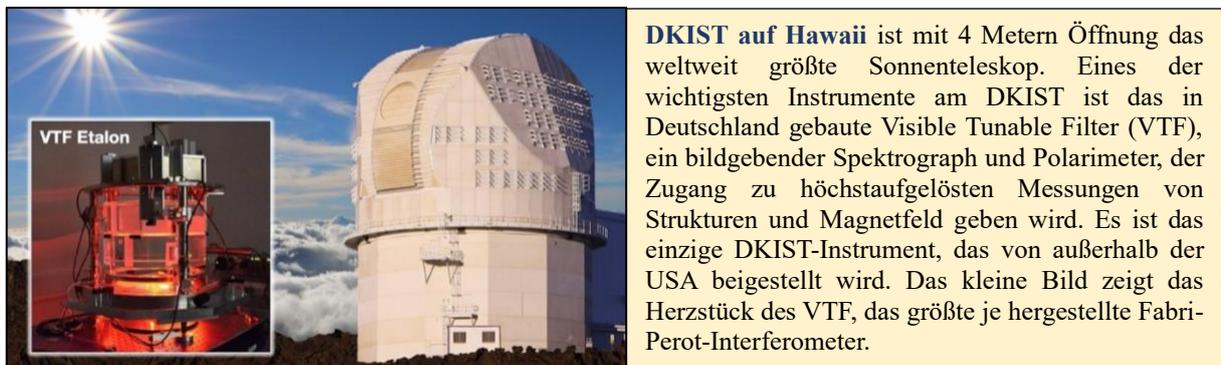
**DKIST auf Hawaii** ist mit 4 Metern Öffnung das weltweit größte Sonnenteloskop. Eines der wichtigsten Instrumente am DKIST ist das in Deutschland gebaute Visible Tunable Filter (VTF), ein bildgebender Spektrograph und Polarimeter, der Zugang zu höchst aufgelösten Messungen von Strukturen und Magnetfeld geben wird. Es ist das einzige DKIST-Instrument, das von außerhalb der USA beigestellt wird. Das kleine Bild zeigt das Herzstück des VTF, das größte je hergestellte Fabry-Perot-Interferometer.
